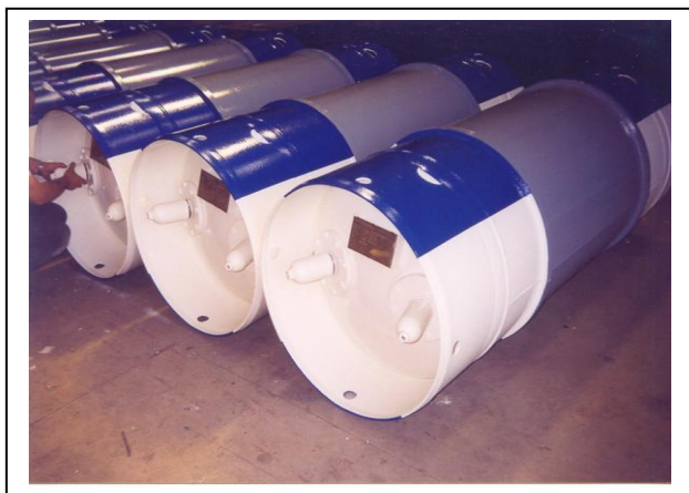
900 I. AMMONIA NH3 TEST PRESSURE 43 bar
