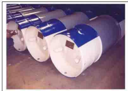
900 L. AMMONIA NH3 TEST PRESSURE 43 bar
