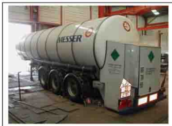
23,4 m 3 . CO2 SERVICE TEST PRESSURE 29,9 bar
